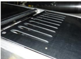
**Runtech a réussi le démarrage de l'embarquement de pointe sur la PM3 d'Arjo Wiggings Bessé.** Notre mission consistait à déplacer des unités Runshooter depuis le dernier cylindre sécheur vers l'enrouleuse à entraînement périphérique. Les anciennes plaques d'embarquement de pointe ont été remplacées par des unités Runshooter et le rouleau inférieur de calandre était équipé avec son propre entraînement.
